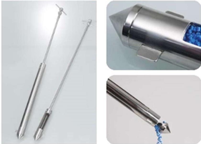
Probenehmer mit dem die Entnahme zahlreicher Proben aus Schüttgütern schnell und einfach möglich ist.
